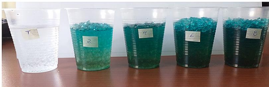
Foto 3.- Resultado del ensayo a 24 horas, donde se observa la hidratación de la lluvia sólida en los 04 tratamientos (incluido el testigo), con el uso de cobre pentahidratado.
